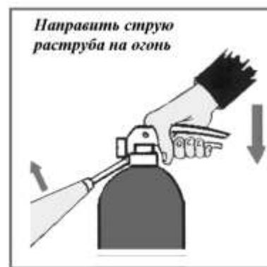
Приведение в действие ручного углекислотного огнетушителя (плакат)
