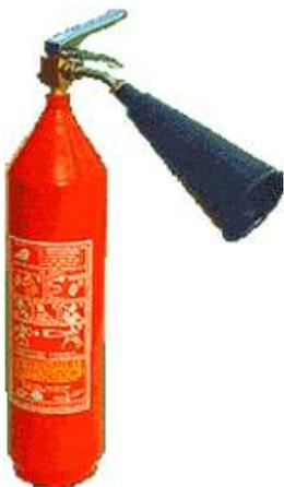
**Назначение:** 1. Огнетушитель углекислотный ОУ-3 (углекислотный) переносной вместимостью баллонов 1.4 и 3 литра предназначены для тушения загораний различных веществ, горение которых не может происходить без доступа воздуха, загораний на электрофицированном железнодорожном транспорте, электроустановок, находящихся под напряжением не более 1000В, загораний в музеях, картинных галереях и архивах.
